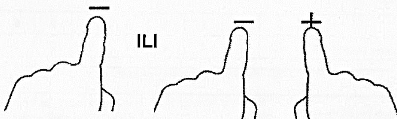
3. Da ploču za kuhanje isključite u potpunosti dodirnete tipku za "uključivanje /isključivanje" (①).
