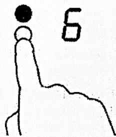
2. Isključite površinu za kuhanje dodirom na tipku "-" (do "0") ili pritisnite tipke "-" i "+" zajedno.
